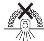
切勿用隔热材料覆盖灯具
