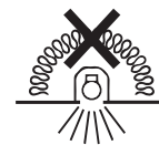
照明器具を断熱材で覆わないこと
