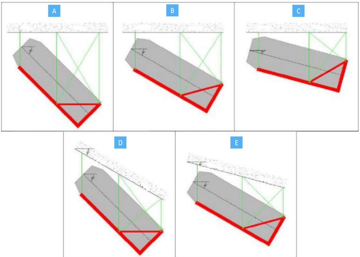
Fig. 59 *Some possible angled configurations: A) relative inclination 45°, B) relative inclination 30°, C) relative inclination 15°, D) absolute inclination 45°, E) absolute inclination 30°*
